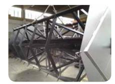
I dischi che costituiscono i Rotori Biologici a Dischi RBD® sono divisi in settori modulari intercambiabili e, così come realizzati, gli stessi non sono sottoposti a tensioni che possano danneggiarli ed una loro eventuale sostituzione può semplicemente avvenire senza la necessità di estrarre la macchina dalla propria sede.
